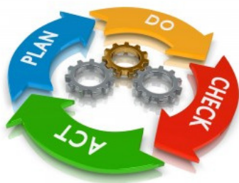
Figuur 5: De Deming cirkel als regelkringprincipe voor (proces)sturing, bestaande uit het steeds doorlopen van de vier stappen 'Plan Do Check Act'
